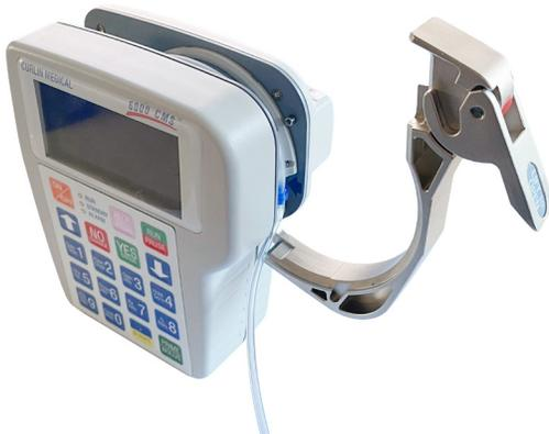
3. Asegúrese de que la línea esté introducida en la ranura delante de la tapa de la bomba a la derecha.
